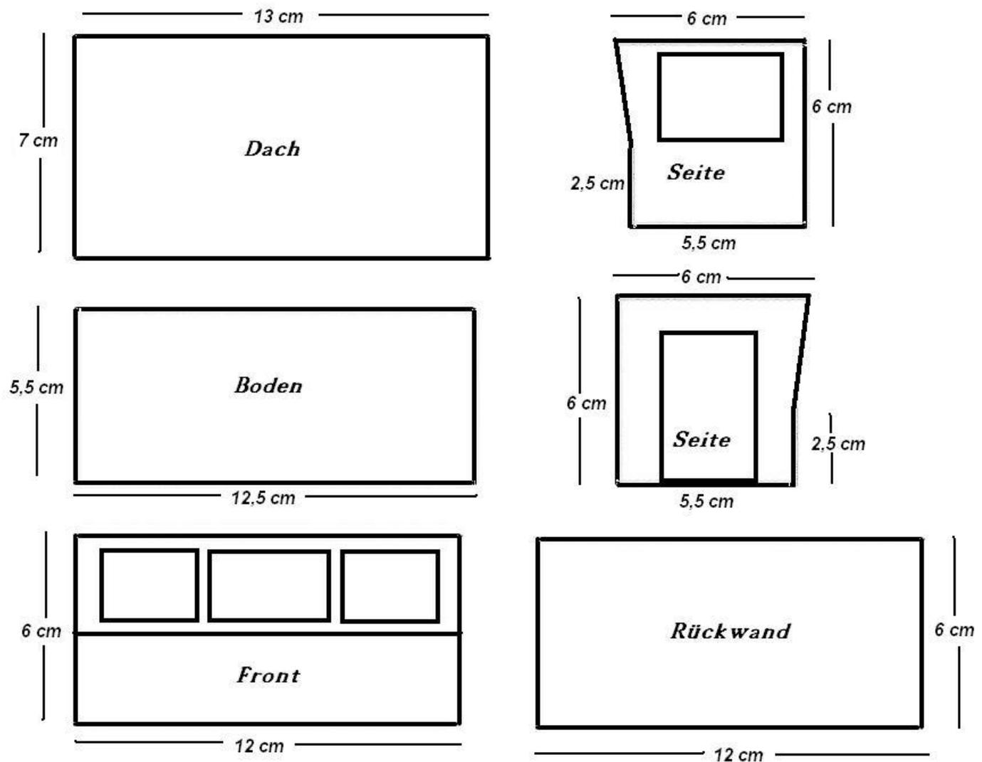
auf der Bodenplatte festgeklebt. Wenn der Holzleim getrocknet ist, wendet man sich der Front zu. Um die Arbeit etwas zu vereinfachen habe ich bei meinen Kommandoständen nur ein großes Fenster in der Front eingeplant. Die Frontplatte wird nun an den Seiten festgeklebt.
